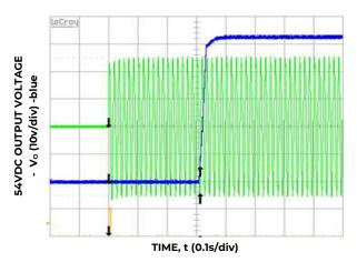
Figure 6. Start up  $V_{\text{IN}}$  176  $V_{\text{AC}}$
